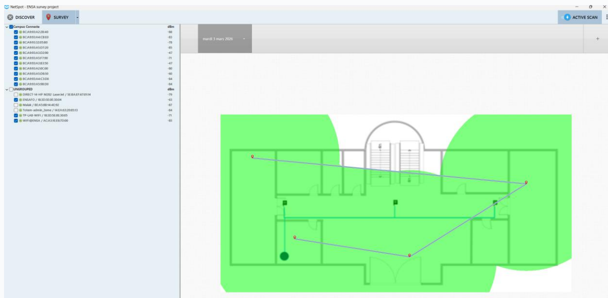
Figure 5 : NetSpot - Carte thermique de couverture Wi-Fi
